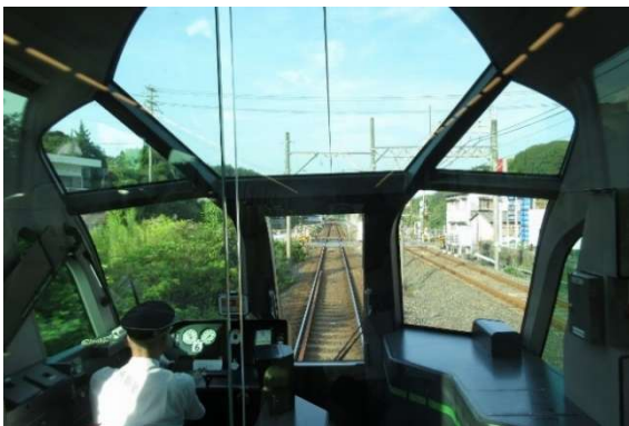
最前列シートからの前面風景。展望列車では異例の前面に非常扉があるのが特徴。運転室とは透明アクリル板で区画。
